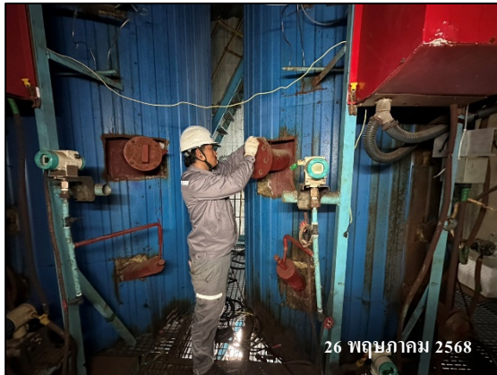
รูปที่ 3.31 การเก็บตัวอย่างคุณภาพอากาศปล่องระบาย
