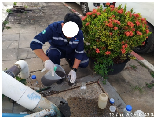
รูปที่ 3.2 ป่อพักน้ำชะมูลฝอยก่อนผ่านระบบบำบัด ฯ เคมี
